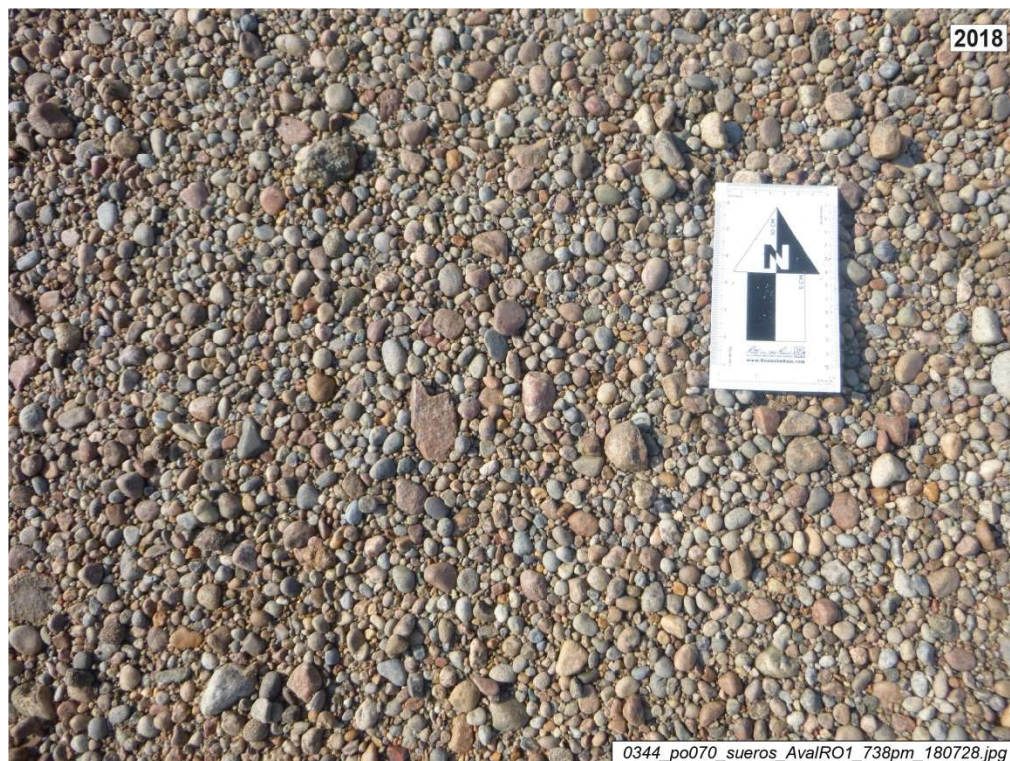
Photos 26 et 27: Partie nord du banc du PK 42,5 en 2018. Les vérifications effectuées en 2018 dans cette partie du banc montrent que la proportion de sable tend à diminuer à la surface du banc et que le pavage de matériaux grossiers est plus continu qu'en 2015.
