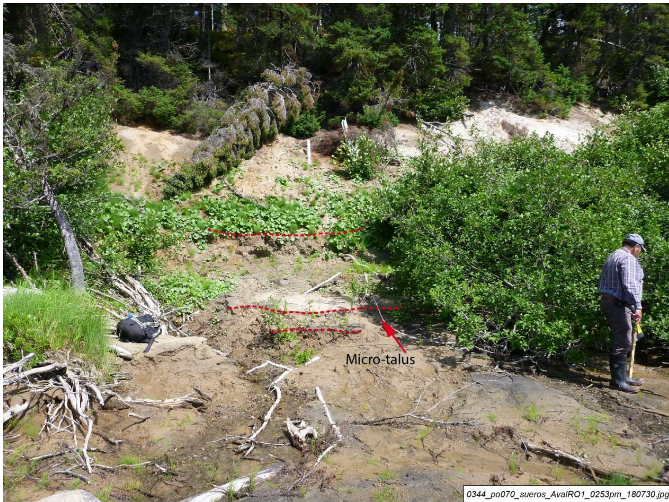
Photo A4-28 : Station témoin 2015-PG-03, rive droite PK 6. Le profil du talus de la station 2015-PG-03 a subi de légères modifications depuis 2015. Des micro-talus qui se sont développés à différents niveaux au pied du talus principal résultent probablement de l'attaque des vagues lorsque le niveau de la rivière est élevé (au printemps, en période de crue ou encore pendant les pointes estivales).
