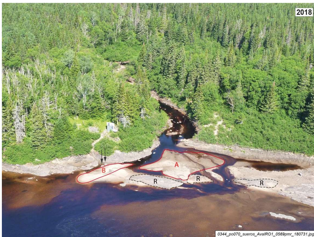
Photo A5-16 et A5-17 : Depuis 2015, des accumulations de sable se sont formées dans l'axe du chenal aval et au centre de l'embouchure du tributaire se jetant vers le PK 34,5 (montrées par les lettres A et B sur la photo A5-17). Ces accumulations ont fait en sorte de dévier l'écoulement entre les aires de roc affleurant et de changer la configuration des chenaux.
