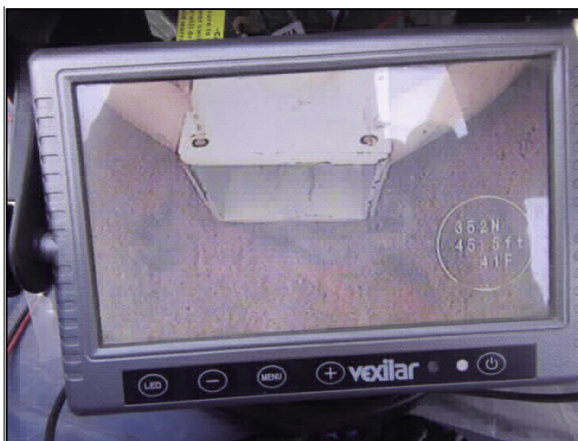
Photo 8 : Image provenant de la caméra installée sur le Helley-Smith (3 juin 2018) Exemple de l'échantillonneur positionné adéquatement sur le lit de la rivière
