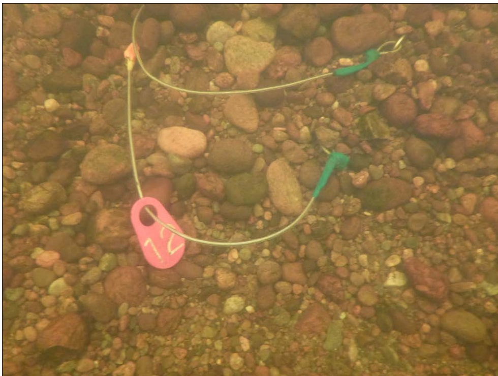
Photo 28 – Support à capsules enfoui dans le substrat d'une frayère de la Romaine.
