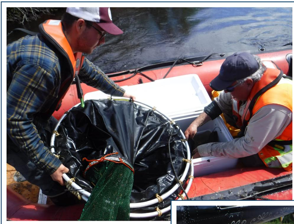
**PHOTO 3** — Levée de la trappe chalut et récupération des poissons capturés
