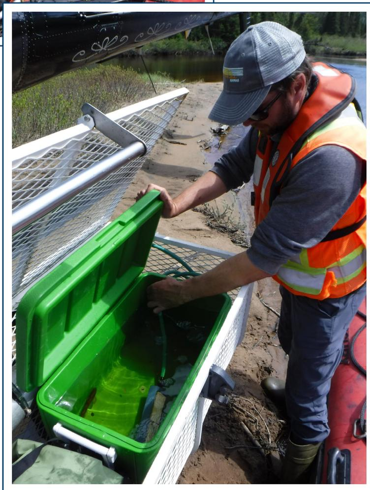
**PHOTO 4** — Glacière munie d'un système d'oxygénation pour le transport hélicoptéré des smolts vers la station piscicole de la SSRR
