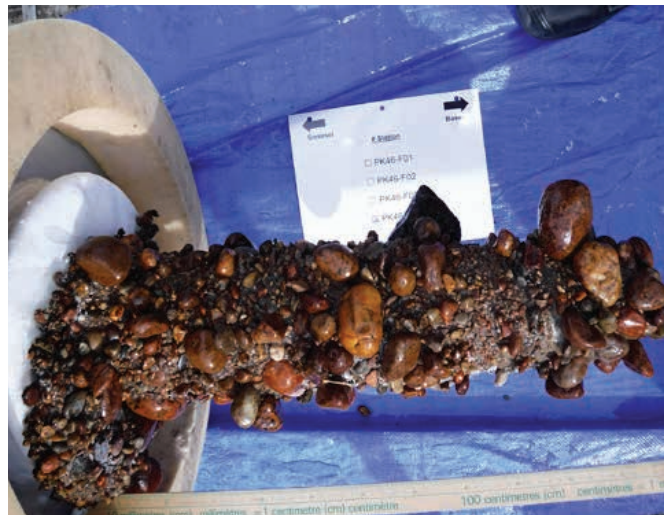
Carotte de sédiments extraite de la frayère du PK 46,2 de la Romaine à l'aide du carottier cryogénique
