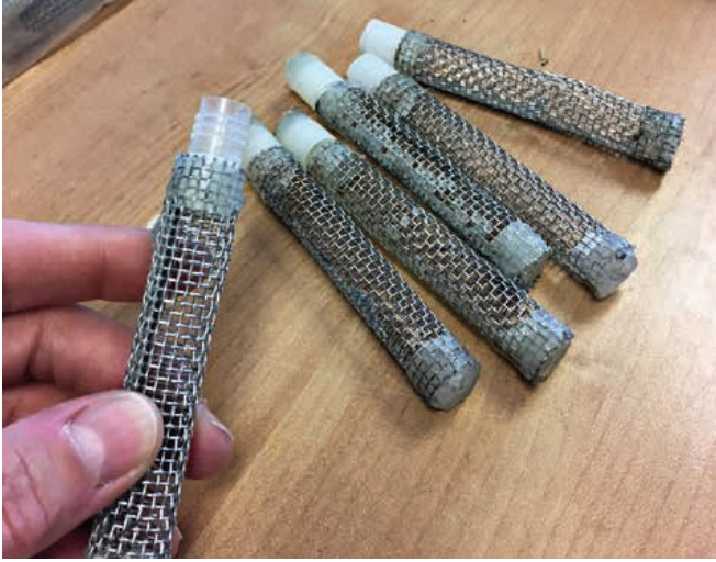
Capsule de développement des œufs implantés dans le substrat des frayères
