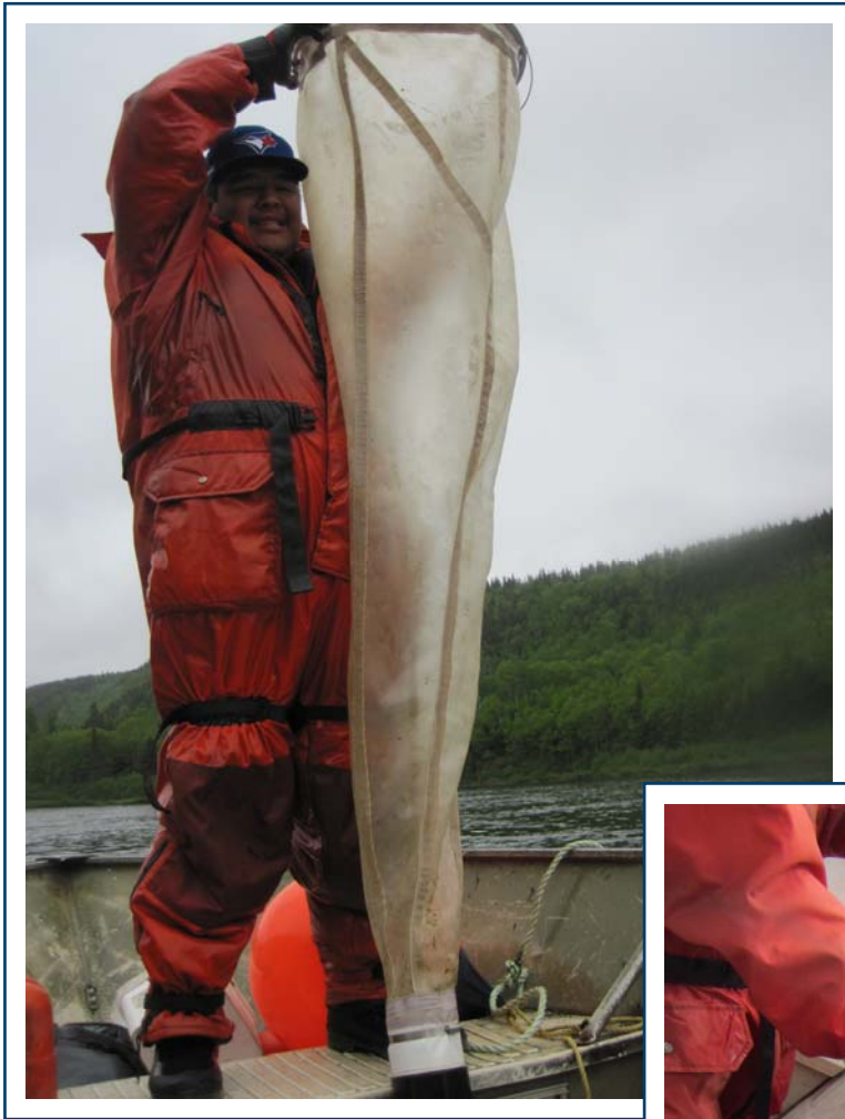
PHOTO 1 — Aperçu d'un filet de dérive utilisé pour la capture de larves de corégoninés dans la rivière Romaine au printemps 2017
