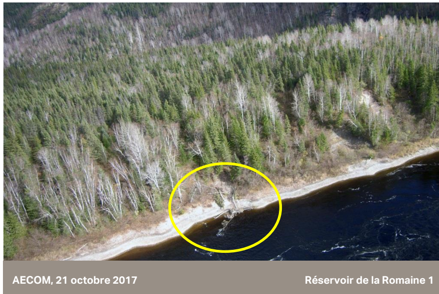
Photo 31 (série) Talus susceptible d'érosion localisé sur la rive est du réservoir de la Romaine 1 en 2017 et 2018 (PK 81,7)
