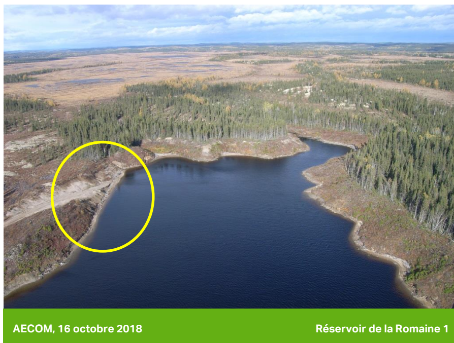
Photo 33 Nouveau talus susceptible d'érosion localisé dans le réservoir de la Romaine 1 (PK 59)
