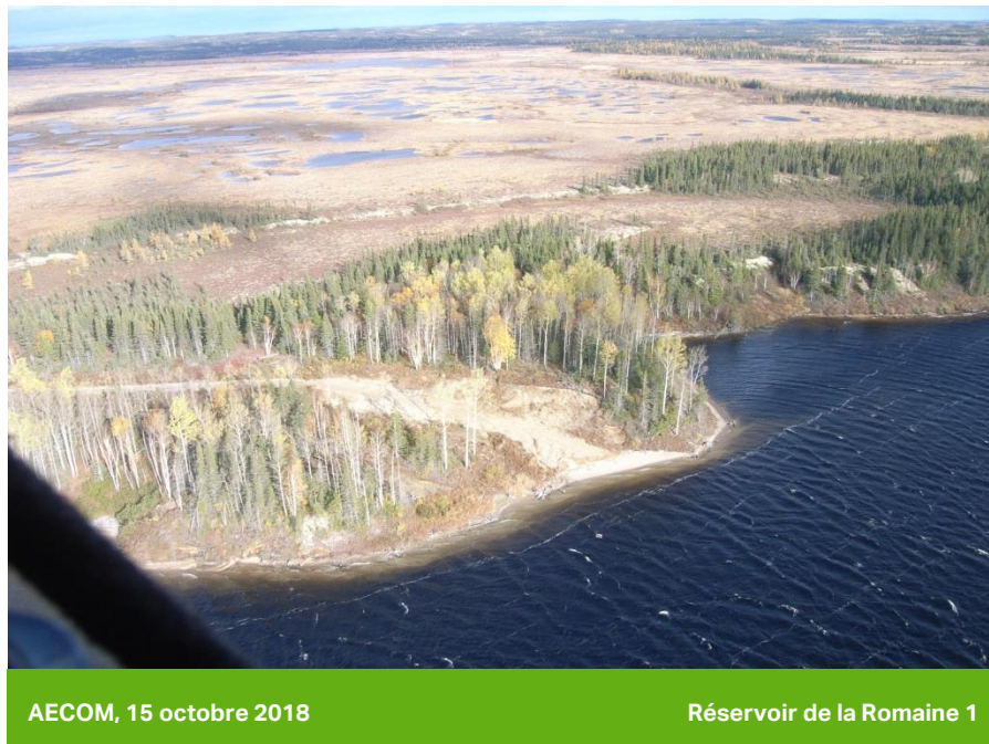
Photo 35 Nouveau talus susceptible d'érosion localisé dans le réservoir de la Romaine 1 (PK 74,5)
