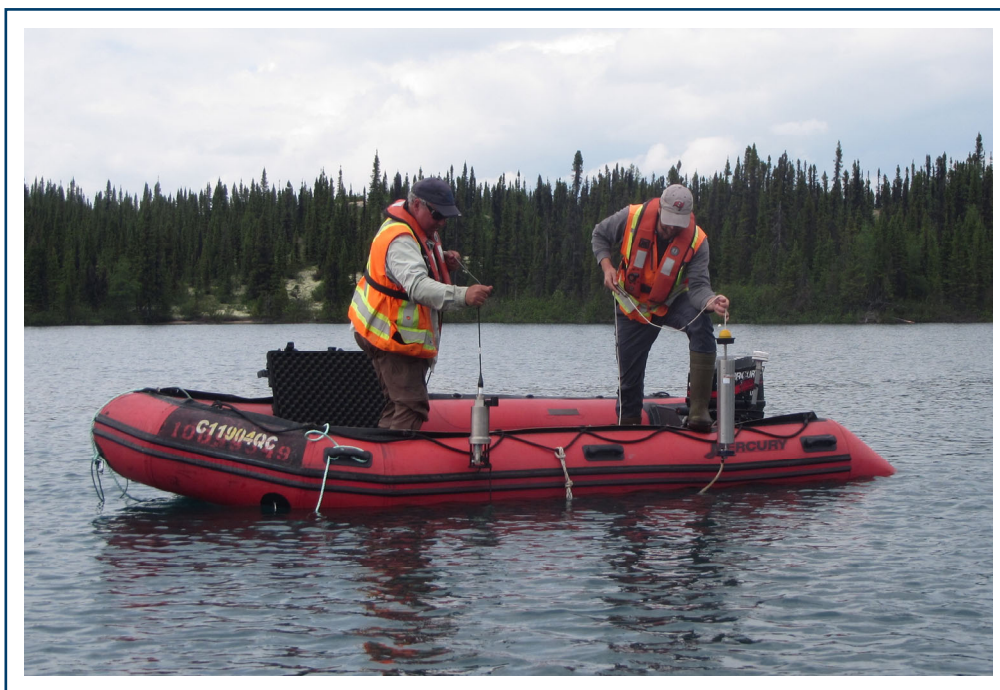
PHOTO 1 — Réalisation d'un profil de qualité de l'eau dans le lac 47 à l'aide de la sonde multiparamètre et prélèvement d'un échantillon d'eau pour les analyses en laboratoire, 15 juillet 2018
