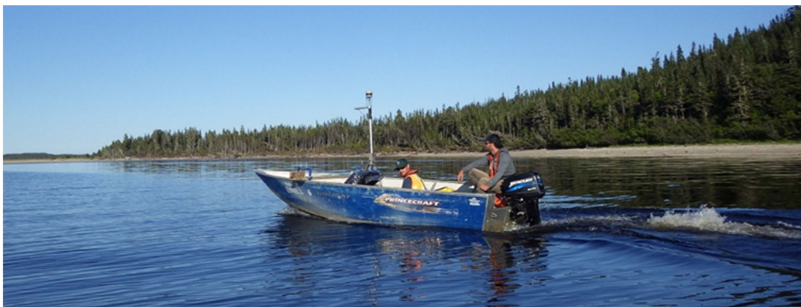
Figure 2.1 – Échosondeur monofaisceau installé sur une embarcation lors des relevés dans l'estuaire de la rivière Romaine
