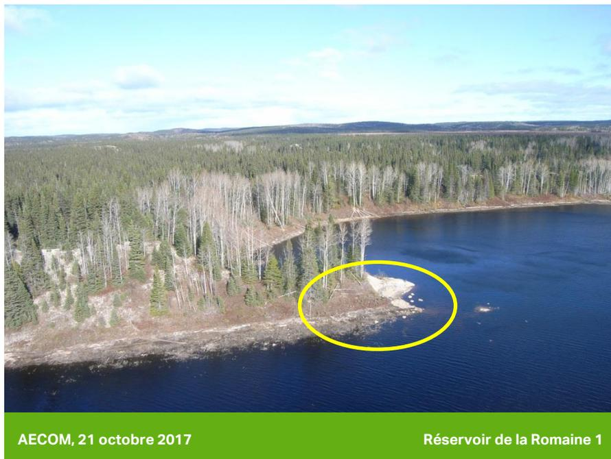
**Photo 28 Talus susceptible d'érosion localisé sur la rive est du réservoir de la Romaine 1 (PK 62,2)**
