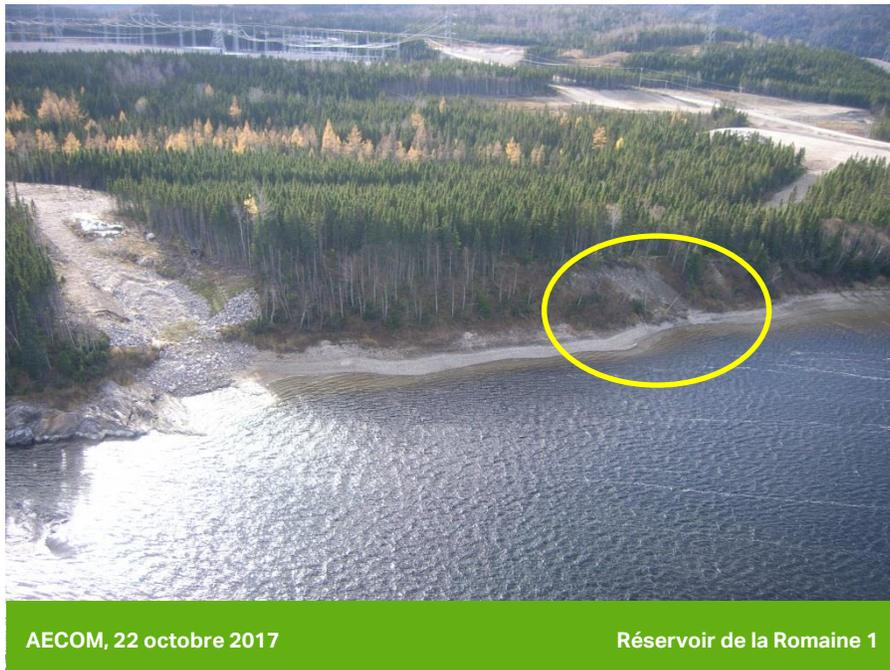
**Photo 32** Talus susceptible d'érosion localisé sur la rive est du réservoir de la Romaine 1 (PK 81,7)
