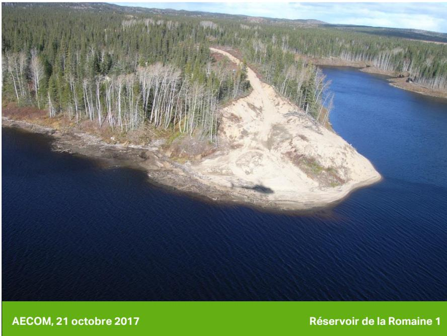
**Photo 29** Talus susceptible d'érosion localisé sur la rive ouest du réservoir de la Romaine 1 (PK 68)
