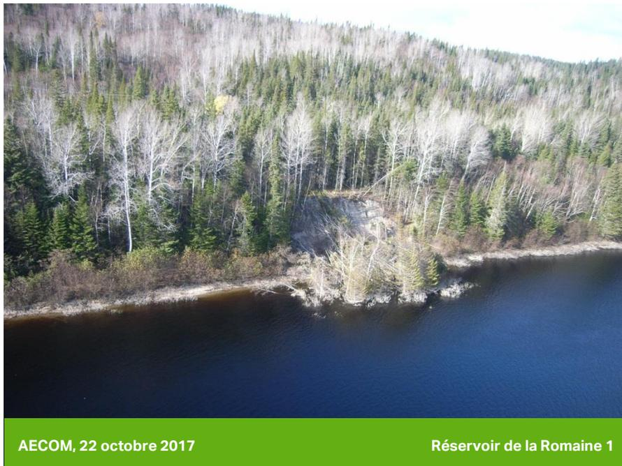
**Photo 31** Talus susceptible d'érosion localisé sur la rive ouest du réservoir de la Romaine 1 (PK 81,8)
