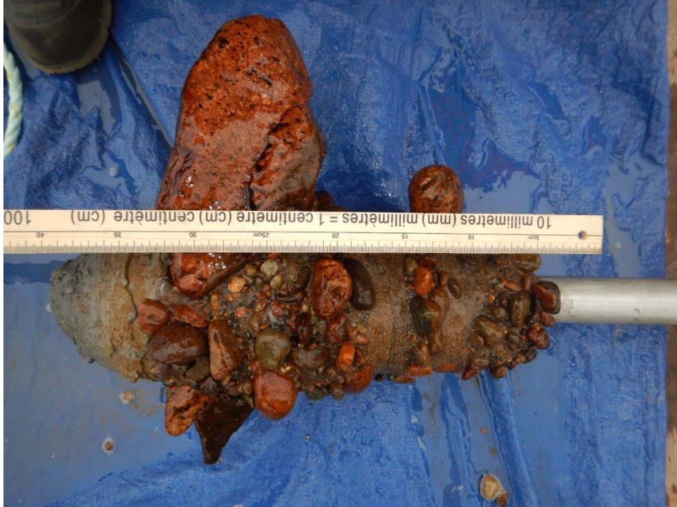
Photo 11 Carotte résultante du forage F05 sur la frayère naturelle au PK 34 de la rivière Romaine
