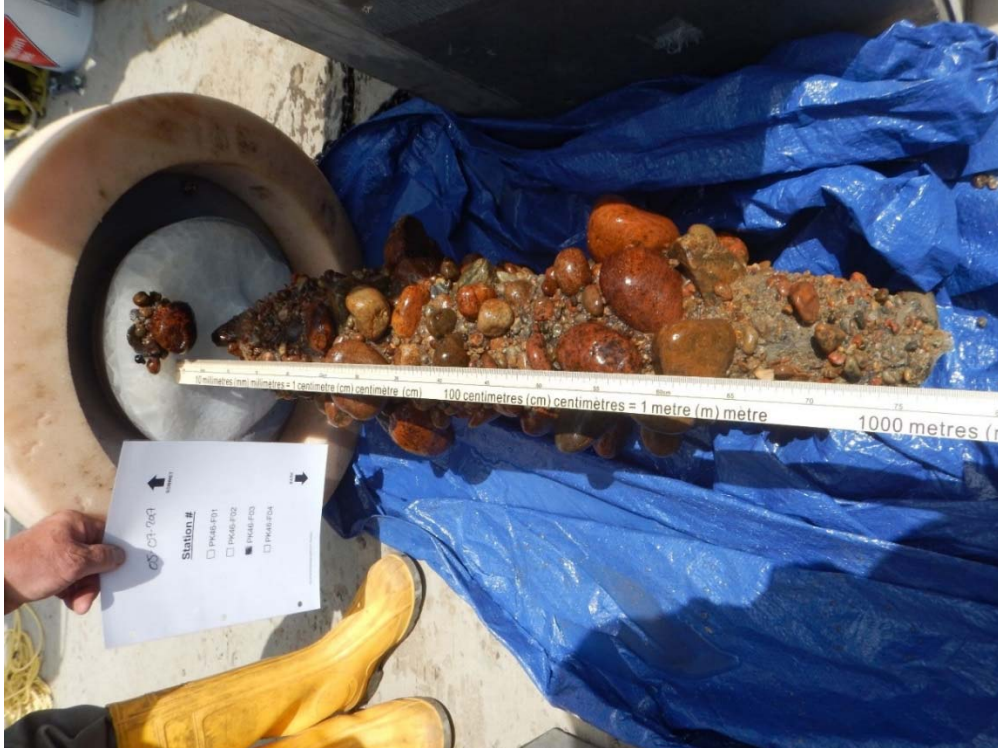
Photo 17 Carotte résultante du forage F03 sur la frayère naturelle au PK 46 de la rivière Romaine
