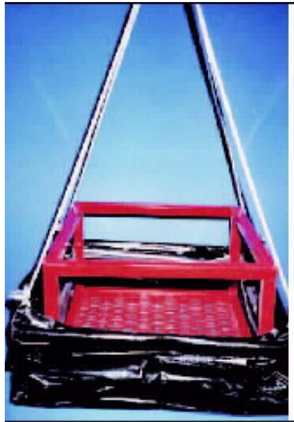
Figure 4-4 Un cube d'infiltration montré avec son sac d'échantillonnage partiellement replié vers le bas avant l'installation.
