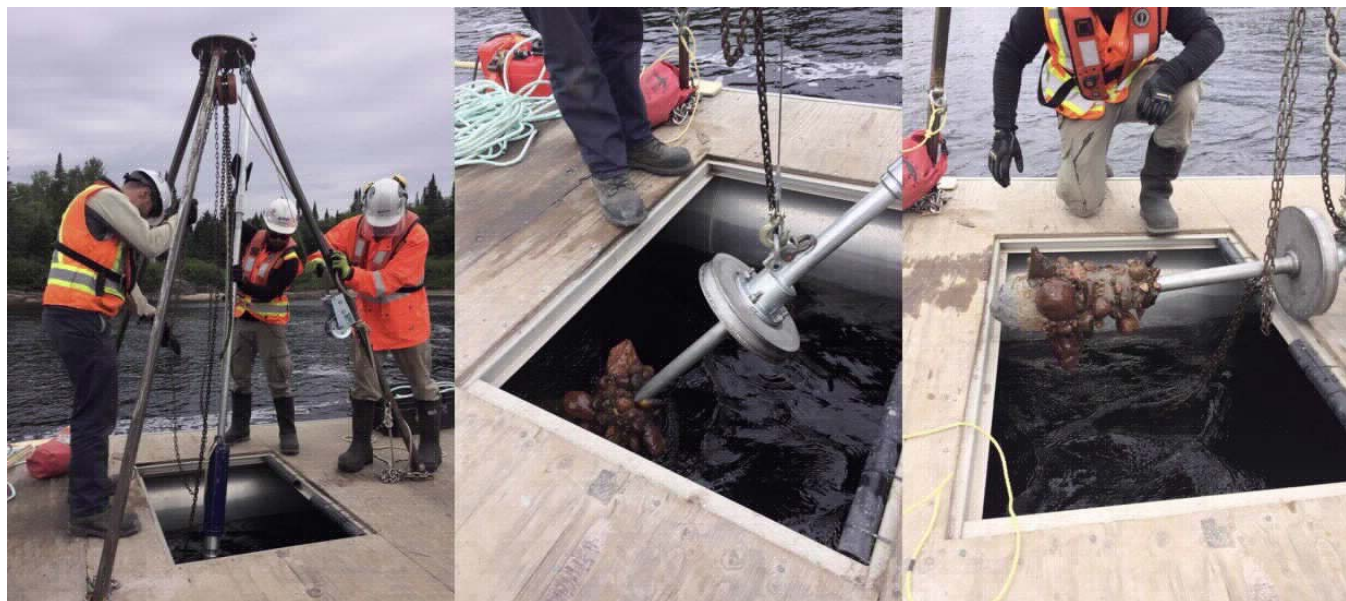
Figure 4-1 Carottier cryogénique utilisé pour le prélèvement de carottes de sédiments dans le substrat des frayères naturelles.
