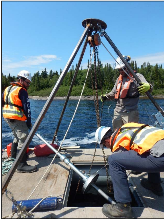
Photo 5 Installation du carottier cryogénique à travers le trou central du ponton de 16 pieds
