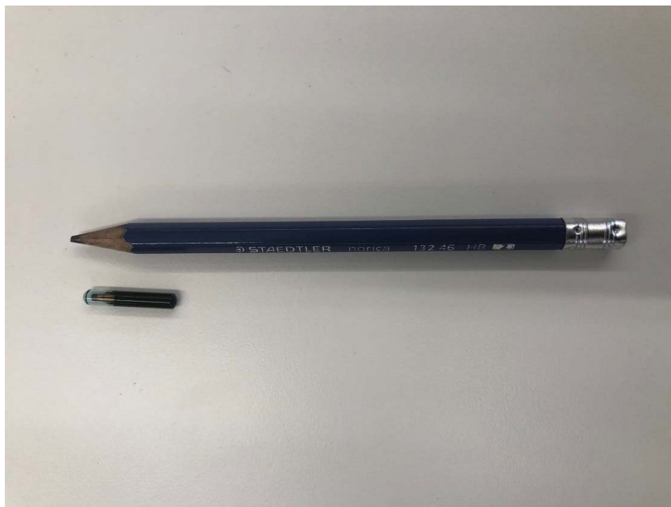
Photo 2 Transpondeur de 24 mm qui est déposé librement dans le tributaire ou inséré dans un galet traceur.
