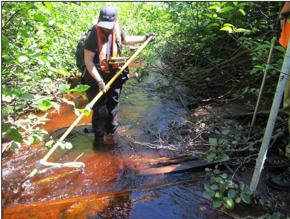
Photo 6 Détection des transpondeurs passifs dans le tributaire au PK 46 de la rivière Romaine
