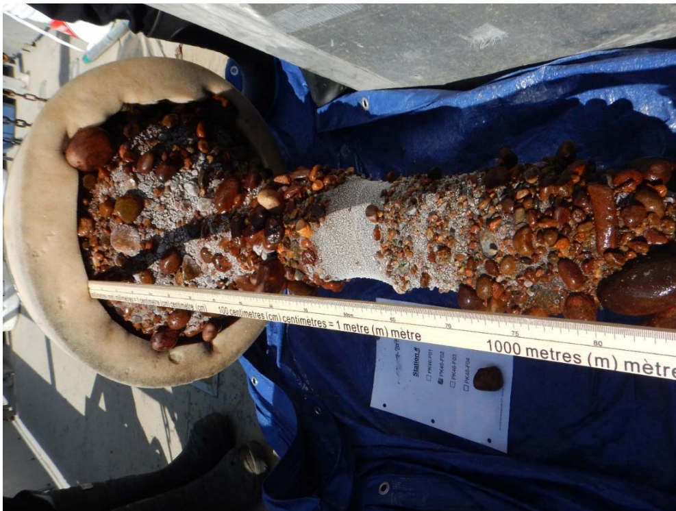
Photo 16 Carotte résultante du forage F02 sur la frayère naturelle au PK 46 de la rivière Romaine
