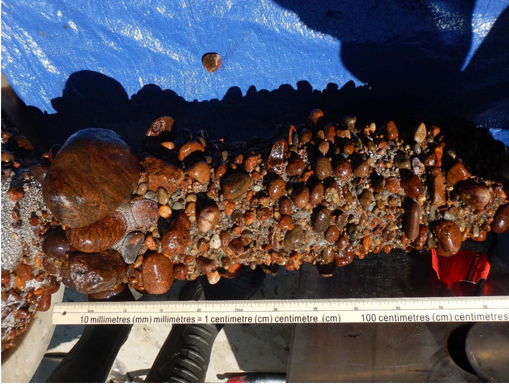
Photo 13 Carotte résultante du forage F07 sur la frayère naturelle au PK 34 de la rivière Romaine
