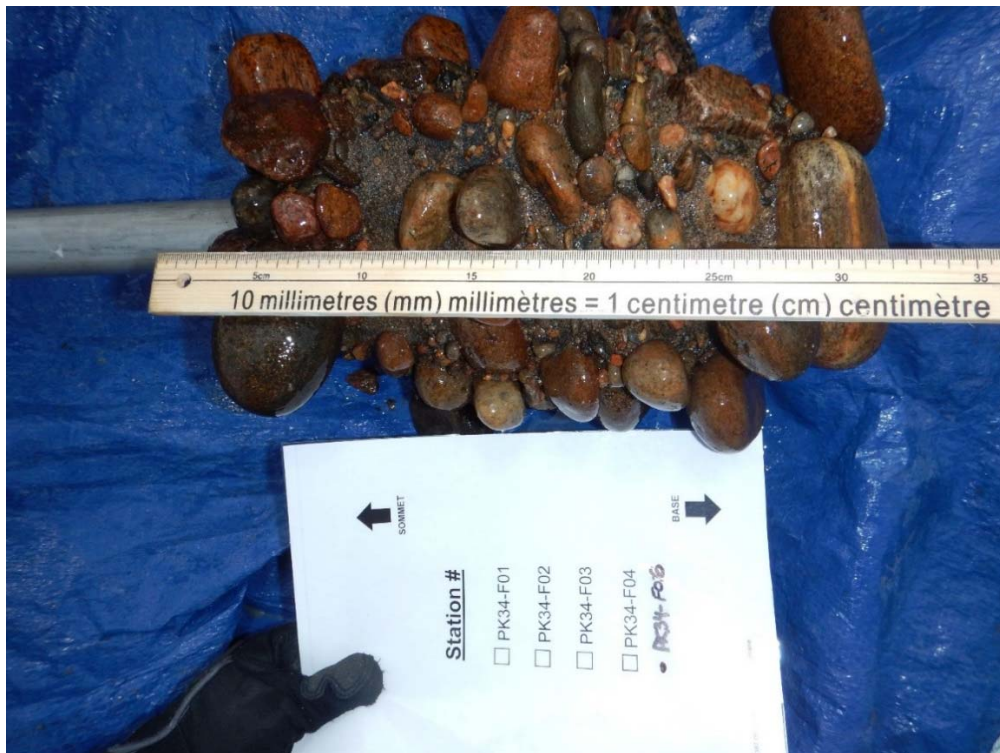
Photo 12 Carotte résultante du forage F06 sur la frayère naturelle au PK 34 de la rivière Romaine
