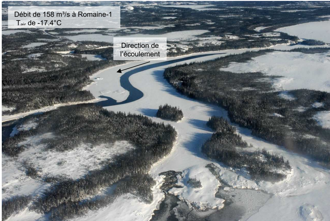
Photo 5 : Éclaircie dans la zone de l'embouchure et écoulement dans le bras secondaire, le 19 janvier 2018
