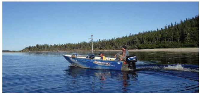
Échosondeur monofaisceau installé dans une embarcation aux fins des relevés bathymétriques de la zone de l'embouchure de la Romaine
