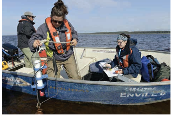
Profilage de la colonne d'eau pour la salinité, la température et d'autres paramètres dans l'embouchure de la Romaine
