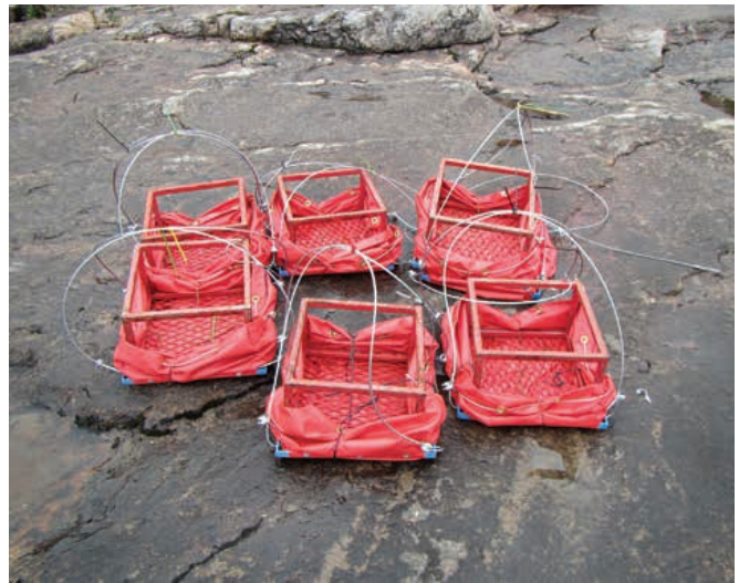
Cubes d'infiltration avant leur installation dans le substrat des frayères
