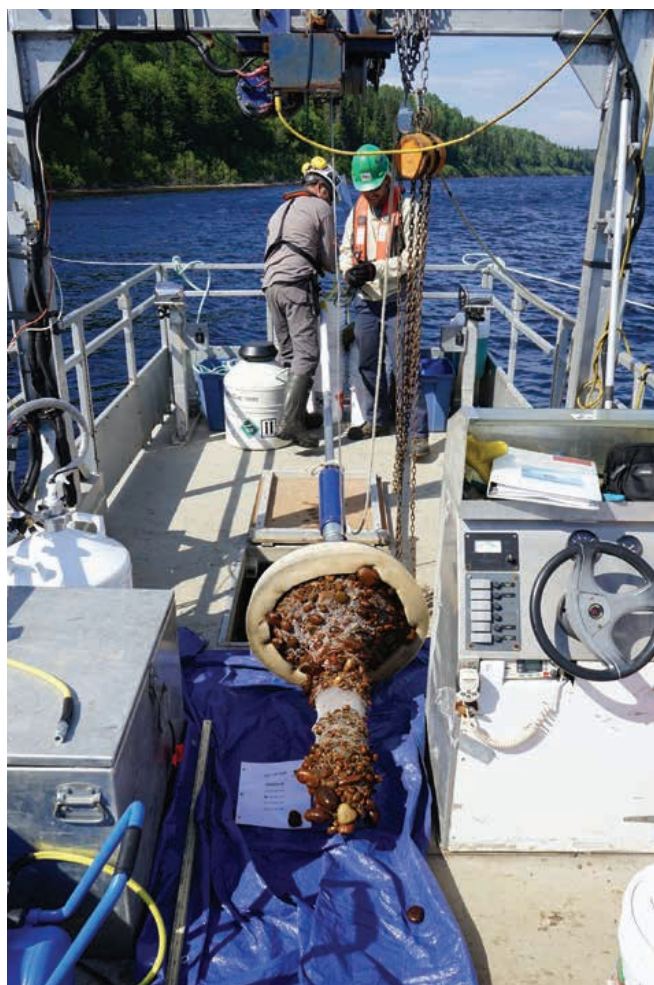
Carotte de sédiments extraite de la frayère du PK 46,2 de la Romaine à l'aide d'un carottier cryogénique
