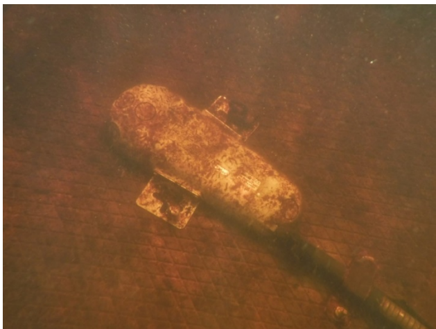
Photo 11 : Léger dépôt sur la sonde SonTek IQ plus le 1 er septembre 2018.
