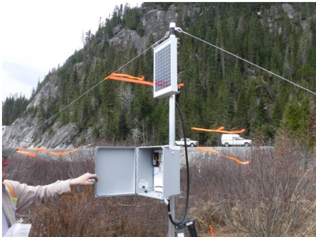
Photo 3 : Boîtier et panneau solaire du système d'enregistrement en continu.
