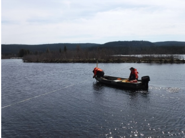
Photo 1 : Établissement du transect lors de la pose de la sonde SonTek IQ plus.
