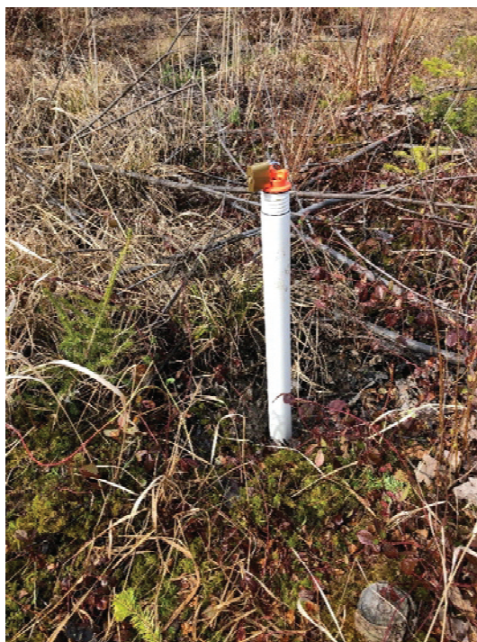
PHOTO 4 Pointe filtrante installée dans l'emprise de la nouvelle ligne (2020)
