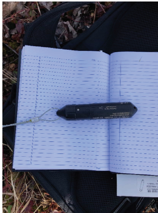
PHOTO 2 Sonde de type « Levelogger » installée dans les piézomètres (2020)
