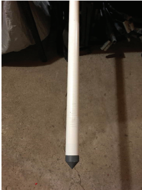
PHOTO 1 Tuyau de plastique crépiné avec bouchon conique (suivi hydrologique 2020)
