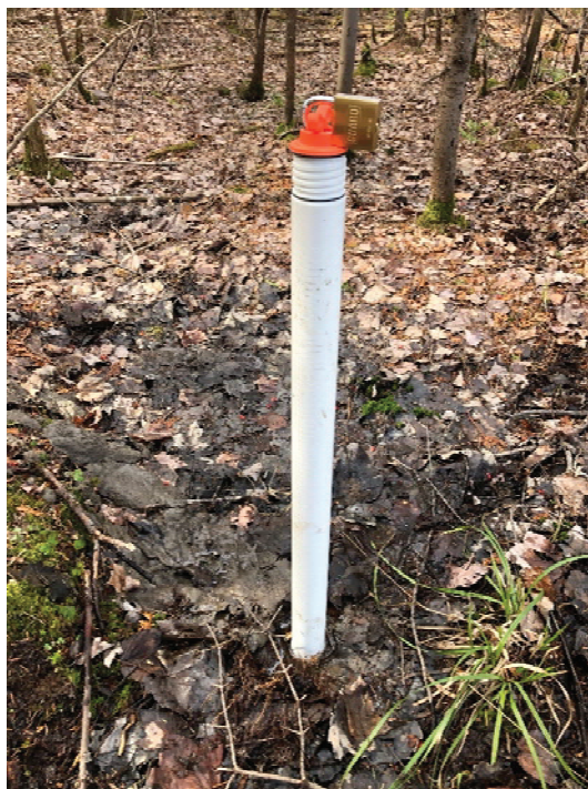
PHOTO 3 Pointe filtrante installée dans le marécage arborescent (2020)
