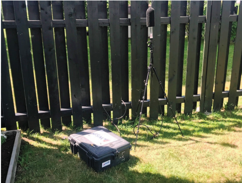
Figure 4 Localisation du point récepteur lors des mesures sonores avec forage
