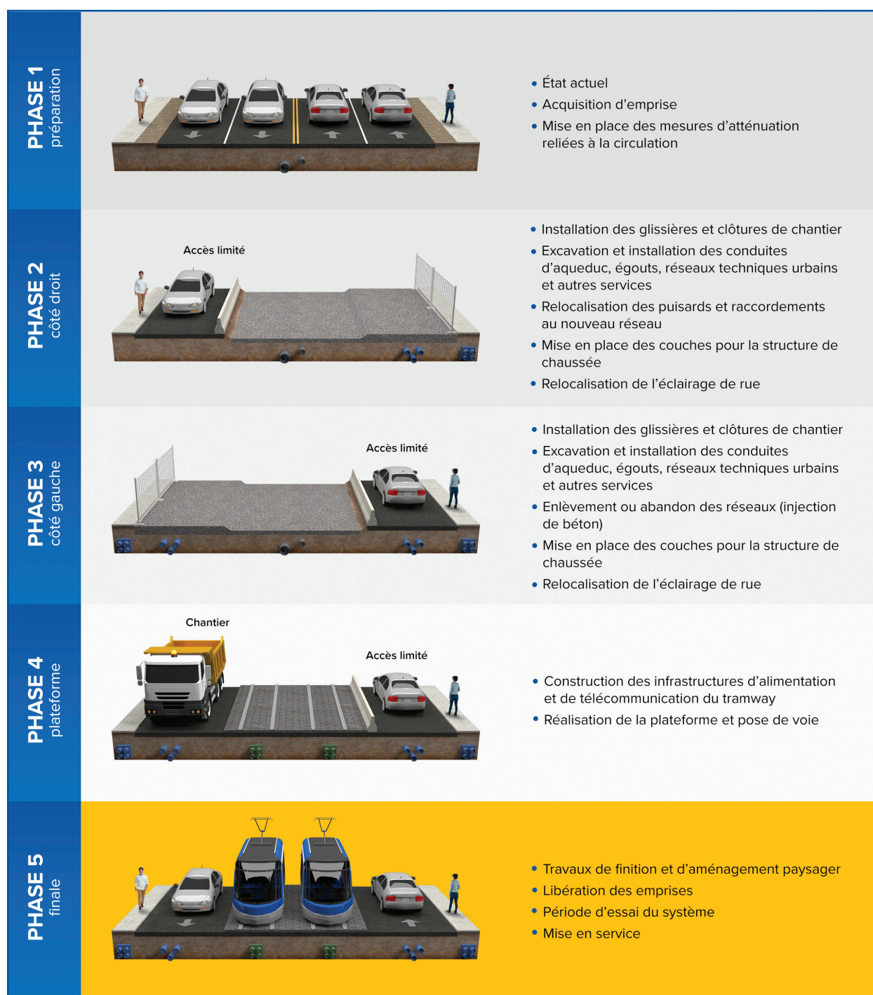
Figure 8 Exemple d'un phasage des travaux de construction du tramway
