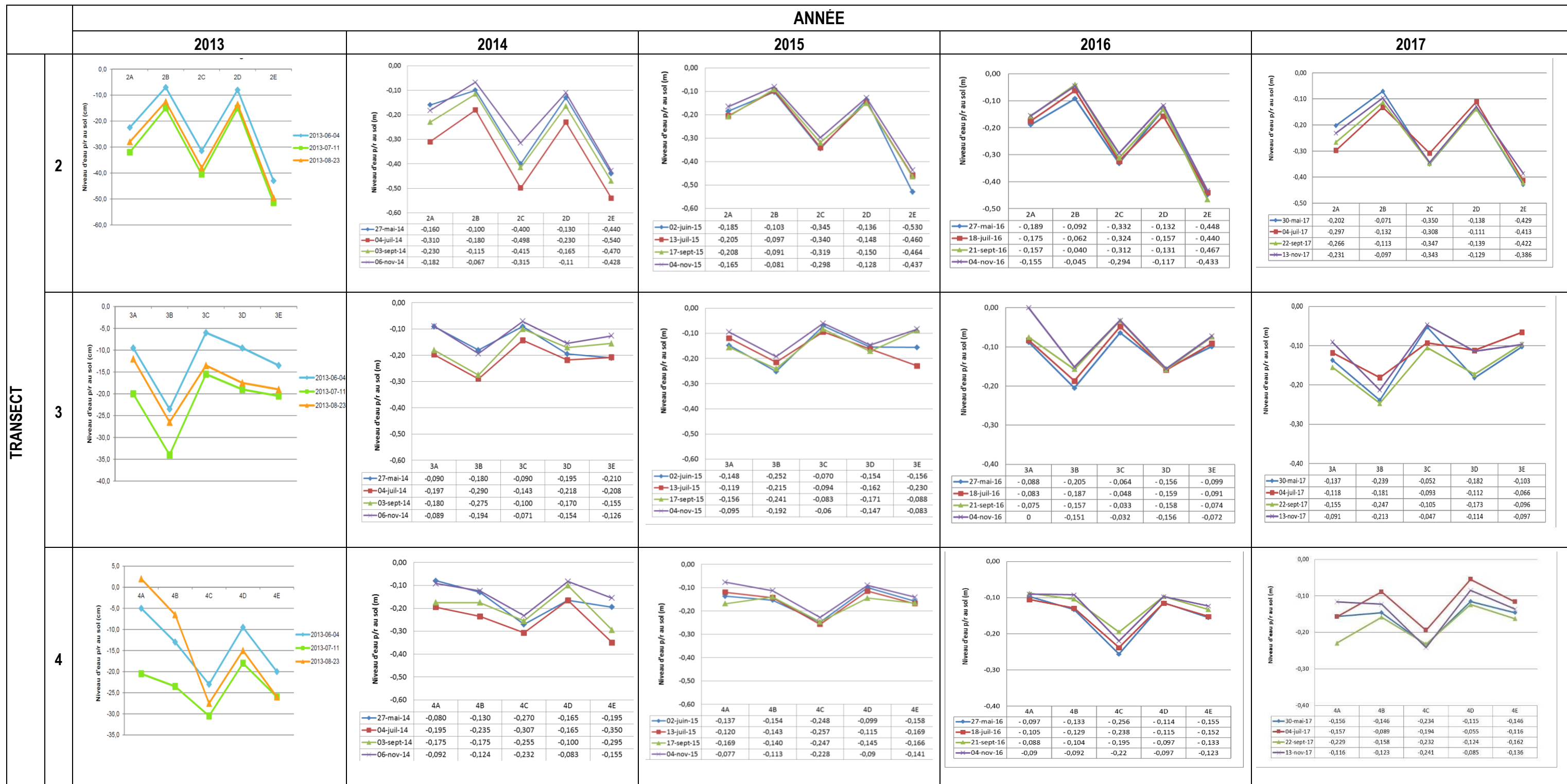
Figure 3-1 : Profondeur comparée de la nappe phréatique à chaque puits d'observation de la zone d'étude (période 2013-2017)
