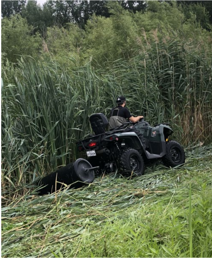
Figure 15. Pliage mécanique à l'aide d'un rouleau à pelouse
