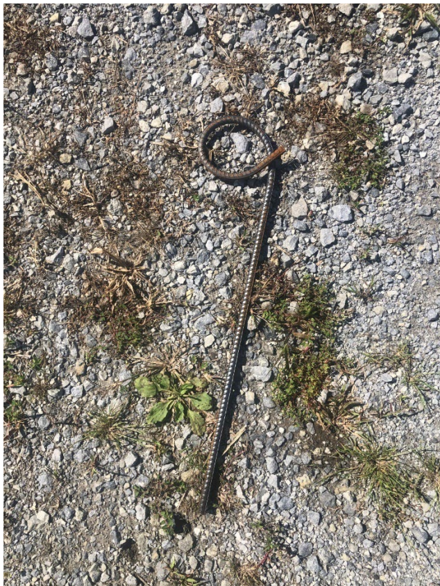
Figure 13. Barre d'armature recourbée servant à l'ancrage du géotextile
