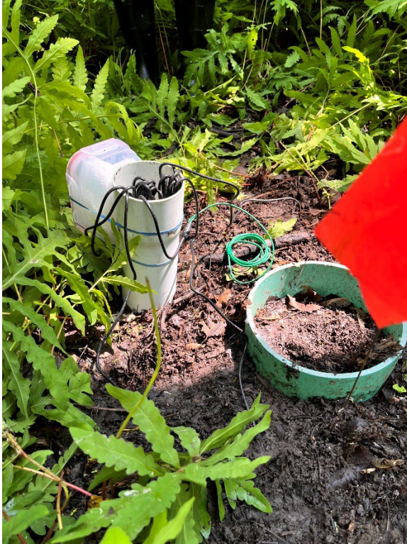
Photographie du dispositif de sondes autour d'un collet carbone
