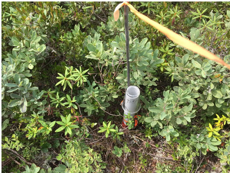
Photo 6 : Puits installé dans la tourbière (T1-50m) (22 août 2022)
