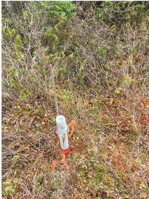
Photo 5 : Puits installé dans la tourbière (T3-30m) (18 mai 2022)
