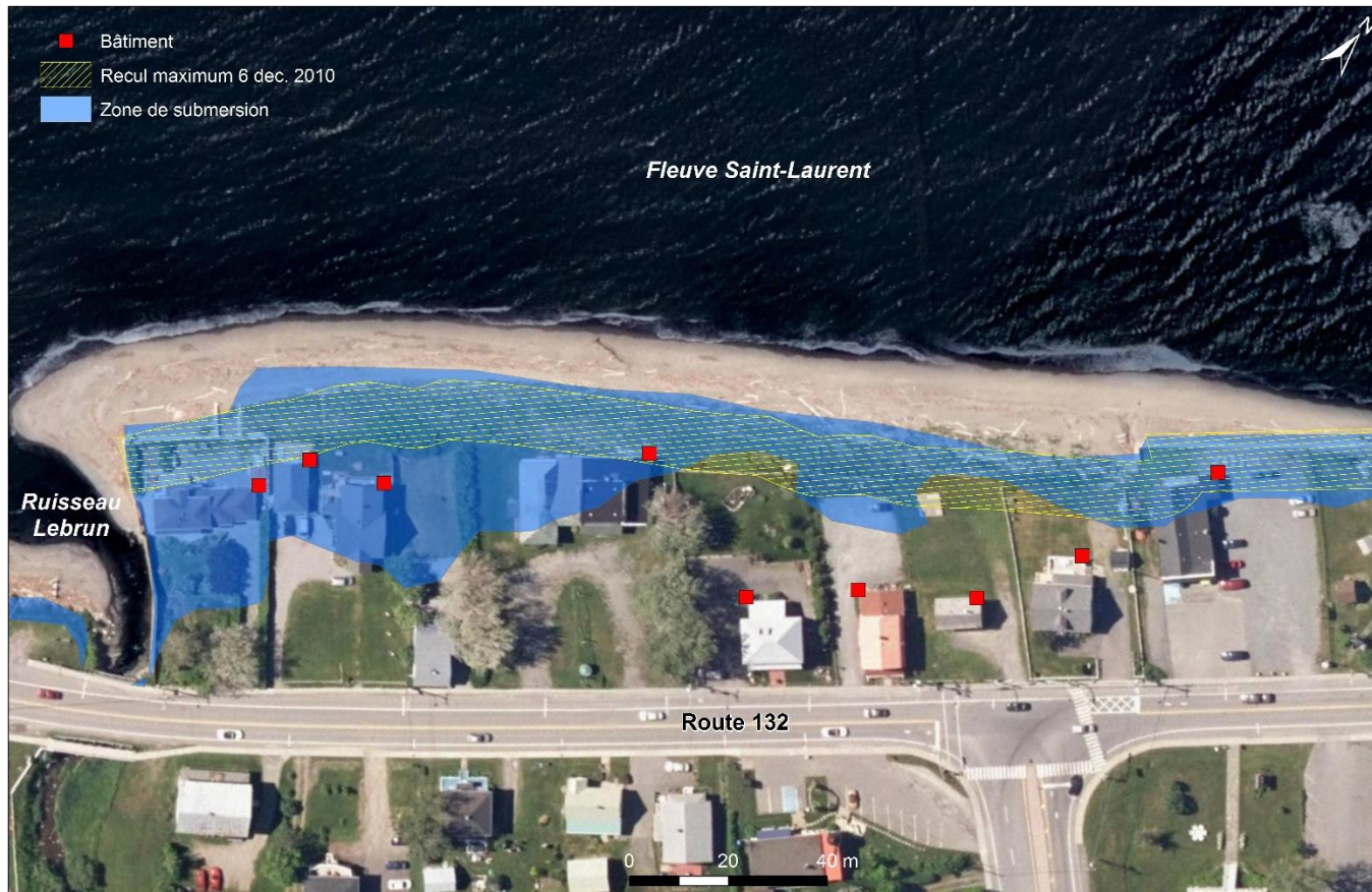
Figure 2 – Éléments exposés à l'érosion et à la submersion côtière Réponse à la question – Courriel du 18 avril 2023 Demande de décret de soustraction (article 31.7.1, chapitre Q-2) Protection des berges contre la submersion et l'érosion côtière Municipalité de Sainte-Flavie
