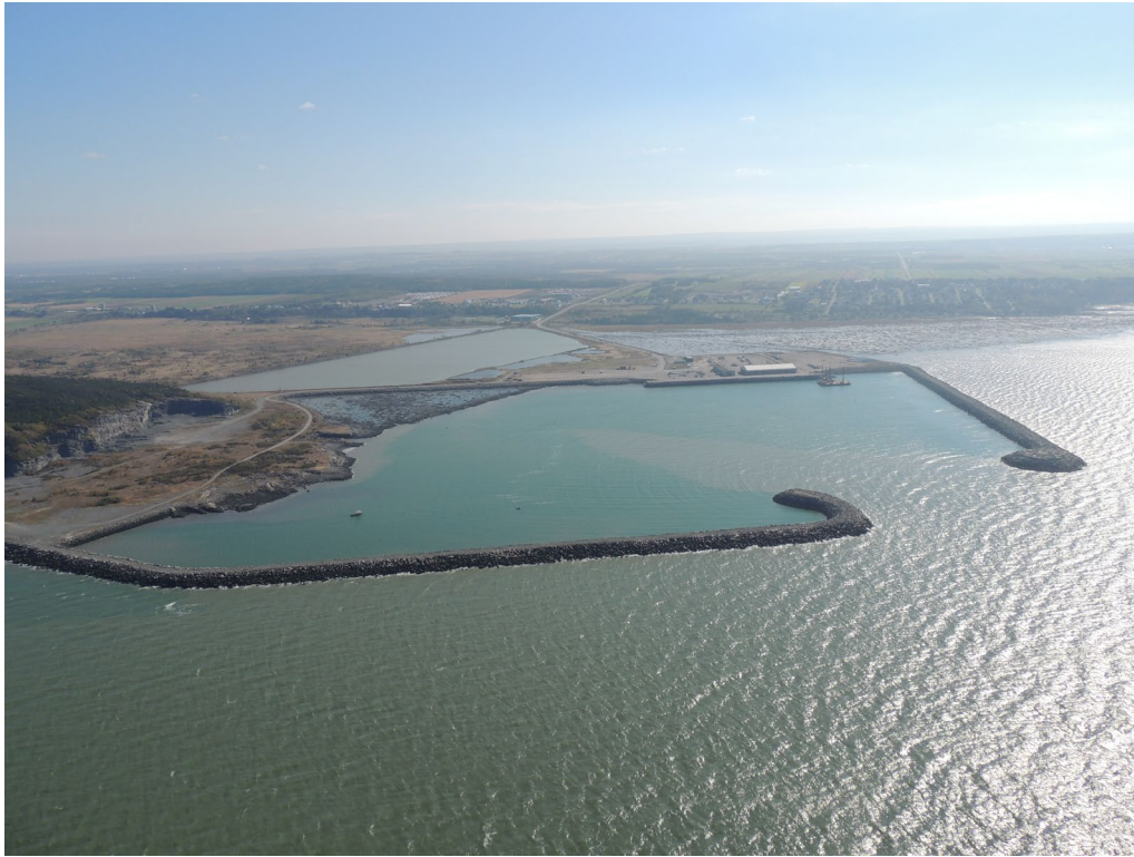
Photo 4.2 : Entrée du panache de sédiments dans le havre à marée montante
