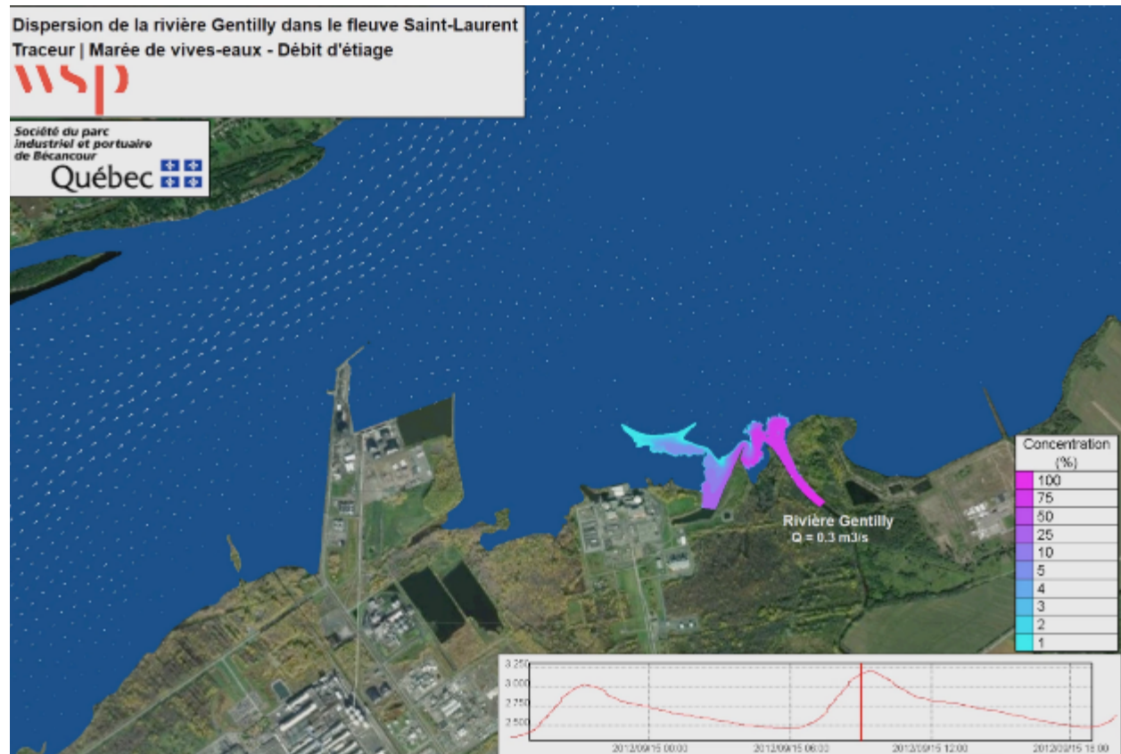
Figure 4-9 Progression maximale du panache de la rivière Gentilly vers l'amont en conditions de débit d'étiage et en marée de vives eaux (WSP, 2021)
