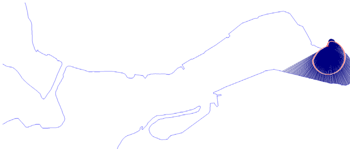
Figure 38 Radiales (bleues) et de la fonction fetch (rouge) pour la génération des vagues au point focal Pointe-aux-Anglais 02
