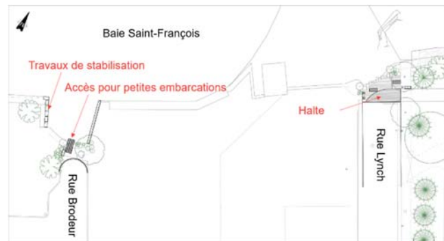
Figure 4-7 Stabilisation à l'extrémité de la rue Brodeur avec autres aménagements à cet extrémité et celle de la rue Lynch
