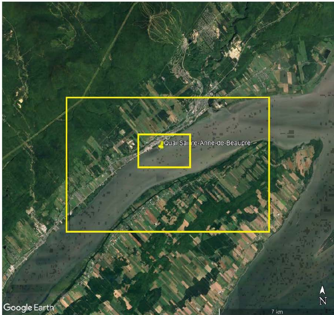
Figure 8 - Grilles utilisées pour l'analyse de la transformation des vagues.
