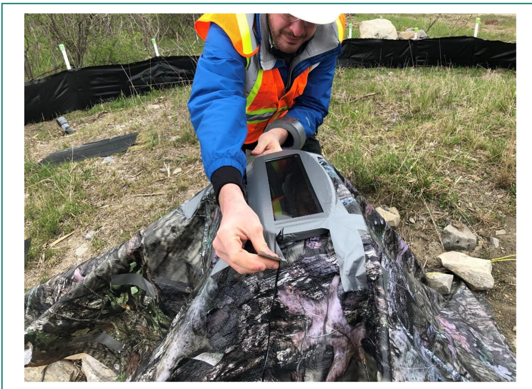
Photo 10 : Panneau solaire comme source d'énergie pour la caméra et le laser
