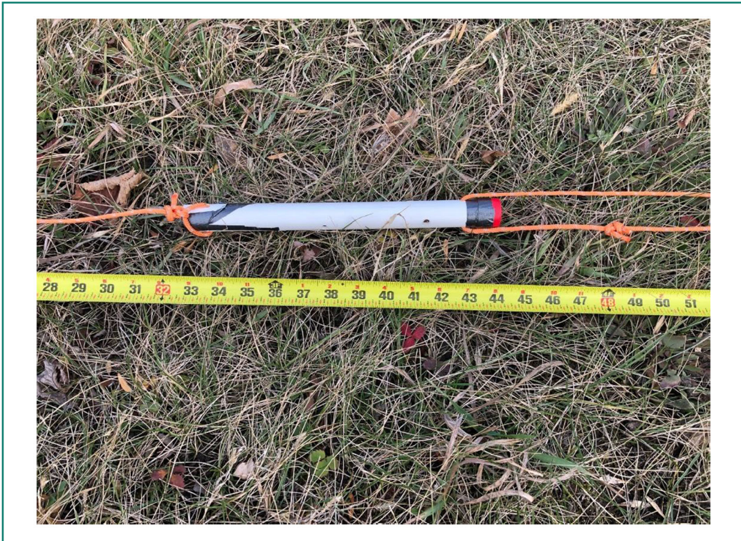
Photo 3 : Sonde de température Thermochron insérée dans un tuyau de PVC
