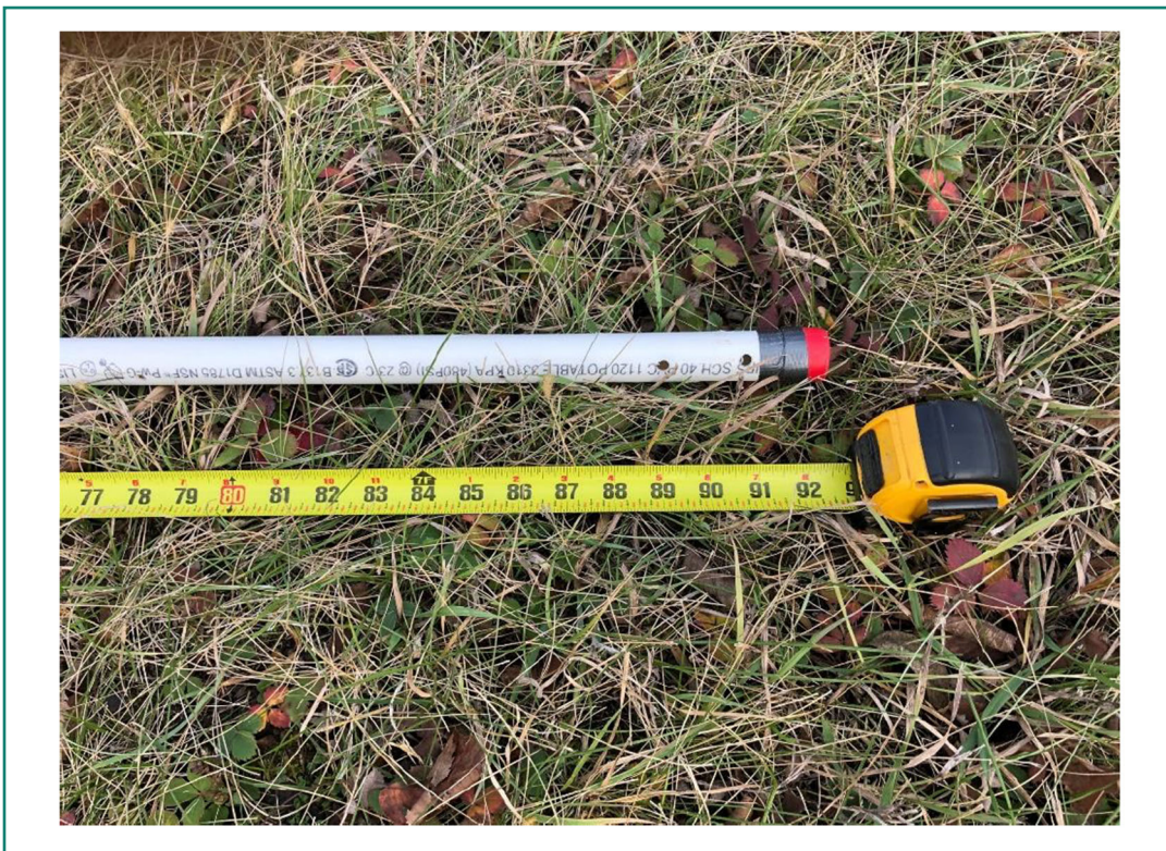
Photo 4 : Sonde de température Thermochron insérée dans un tuyau de PVC
