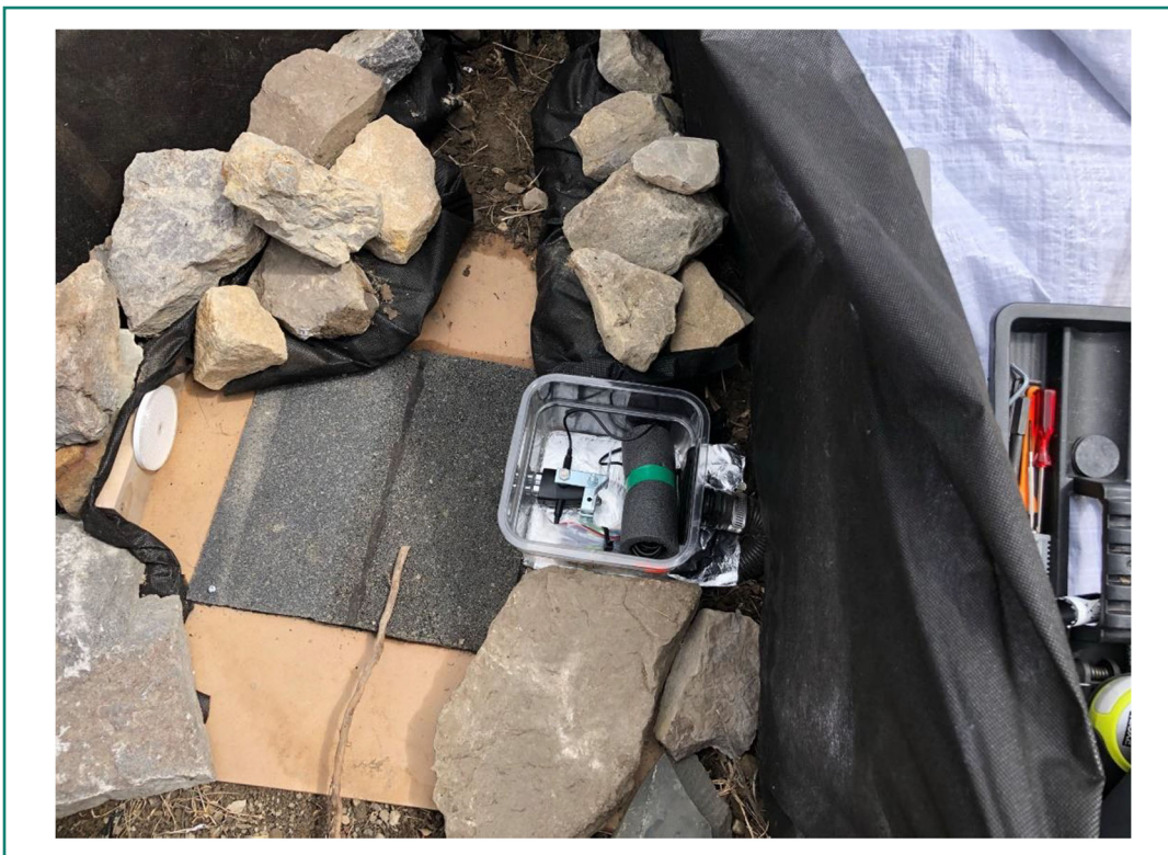
Photo 8 : Beamer laser connecté à la caméra. Lorsque la branche traverse le laser, la caméra est déclenchée.
