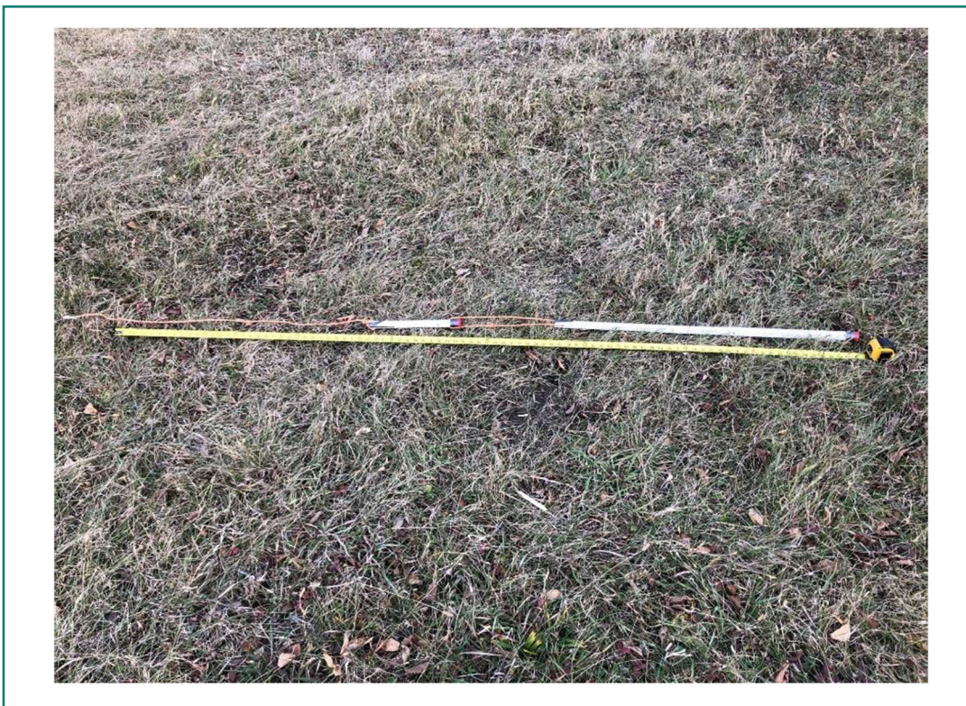
Photo 2 : Sondes de température Thermochron insérées dans un tuyau de PVC
