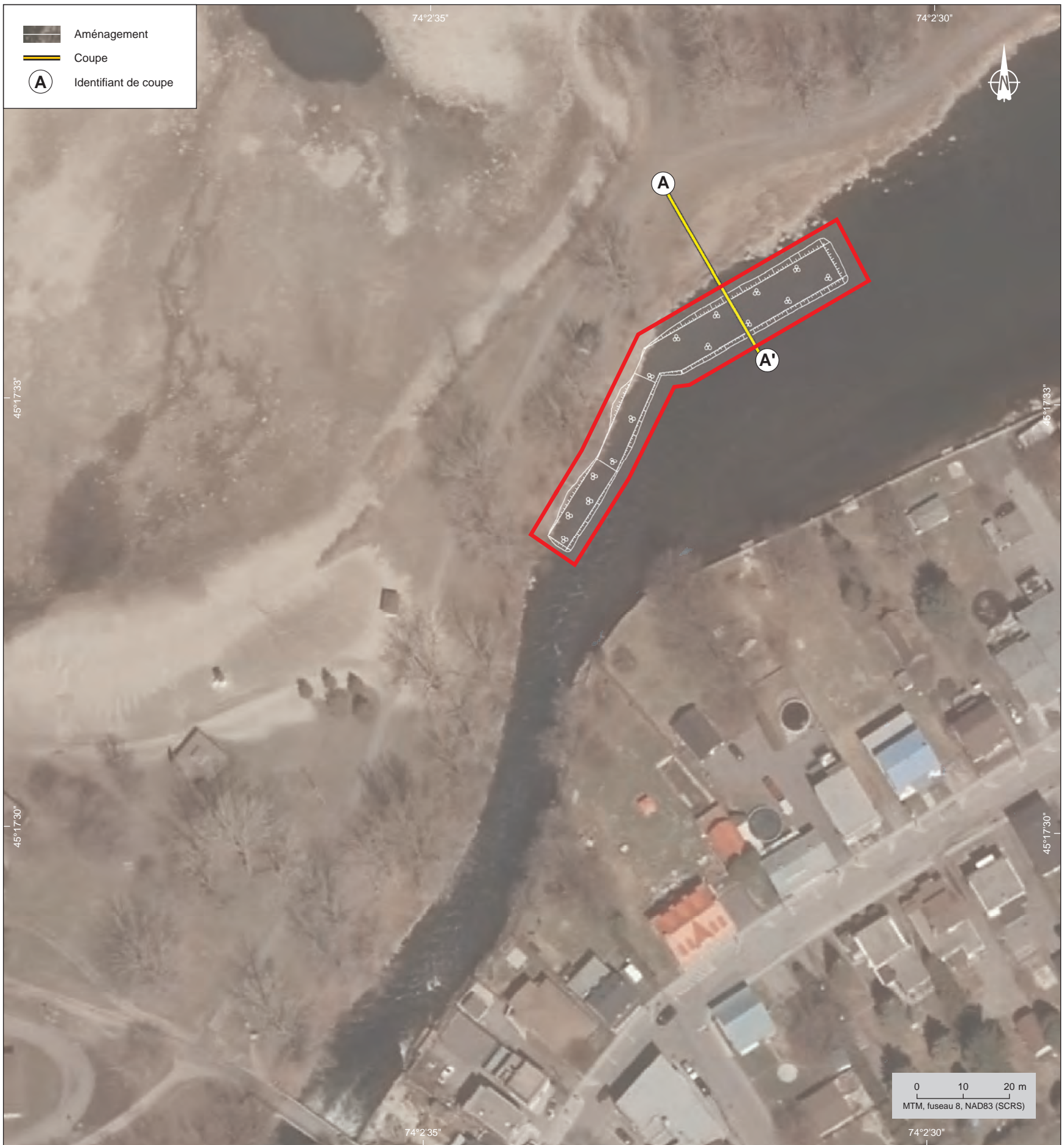
Figure 3 – Aménagement d'une frayère multispécifique en eau vive en aval du premier seuil sur la rivière Saint-Charles (750 m 2 )
