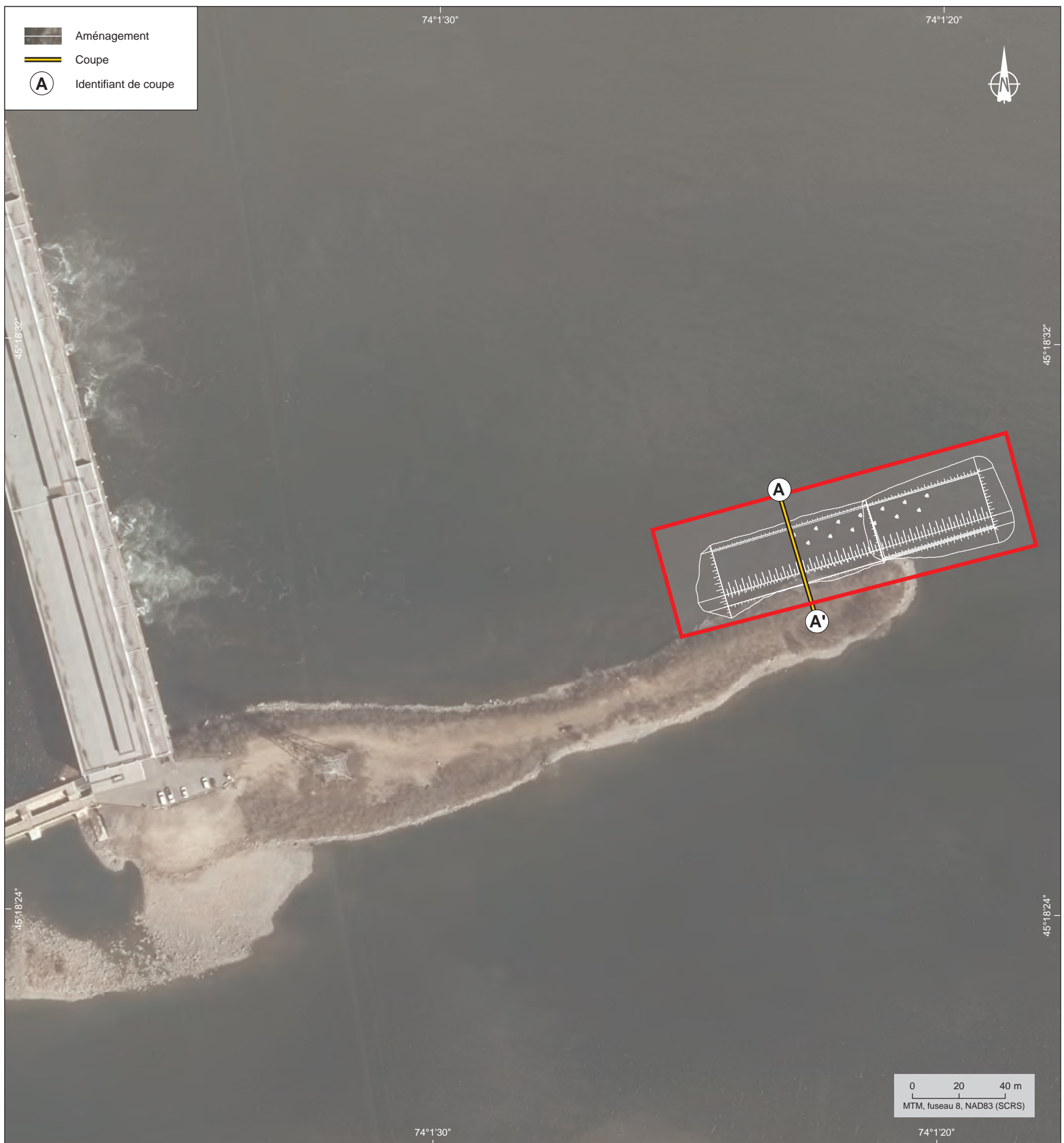
Figure 2 – Aménagement d'une frayère à doré jaune en aval de la centrale des Cèdres (3 000 m 2 )
