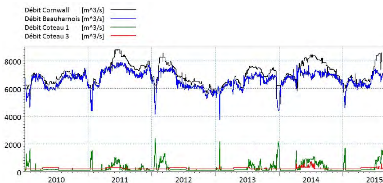
Figure 3-3 Débits journaliers entrant dans le lac à Cornwall et sortant du lac au barrage de Beauharnois, à du Coteau-1 et à du Coteau-3 (Englobe, 2016)
