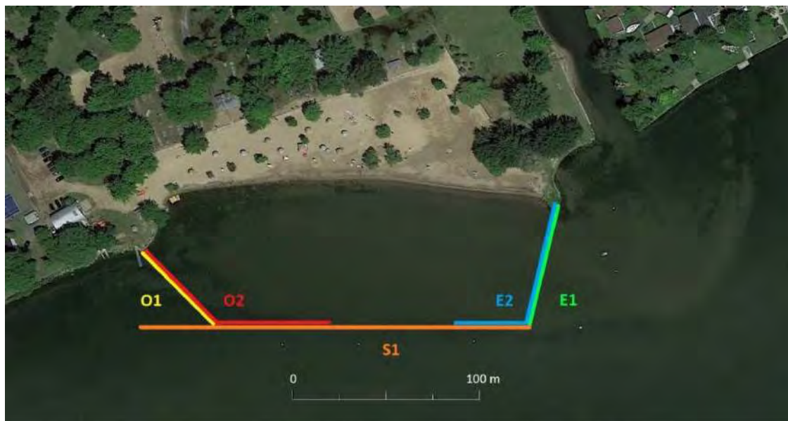
Figure 20 Configurations de brise-lames étudiées, des côtés ouest (O), est (E) et sud (S) de la plage
