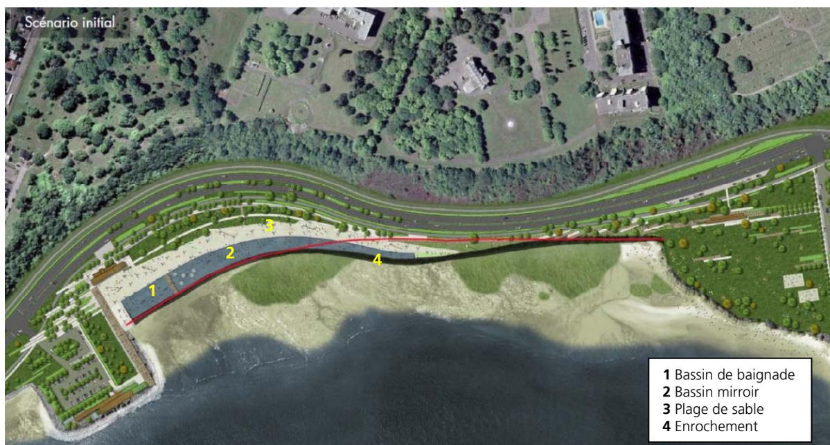
Figure 4 - Scénario initial (la ligne rouge représente la position actuelle du pied d'enrochement)
