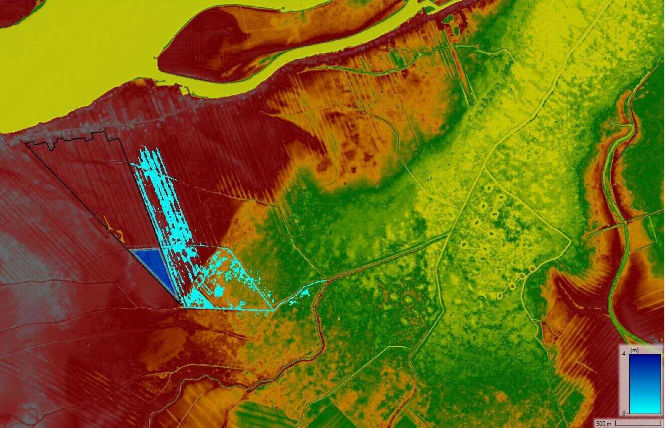
FIGURE A5.1-3 Modélisation de l'impact du bris de l'ouvrage (digue) – simulation 12 heures après une rupture
