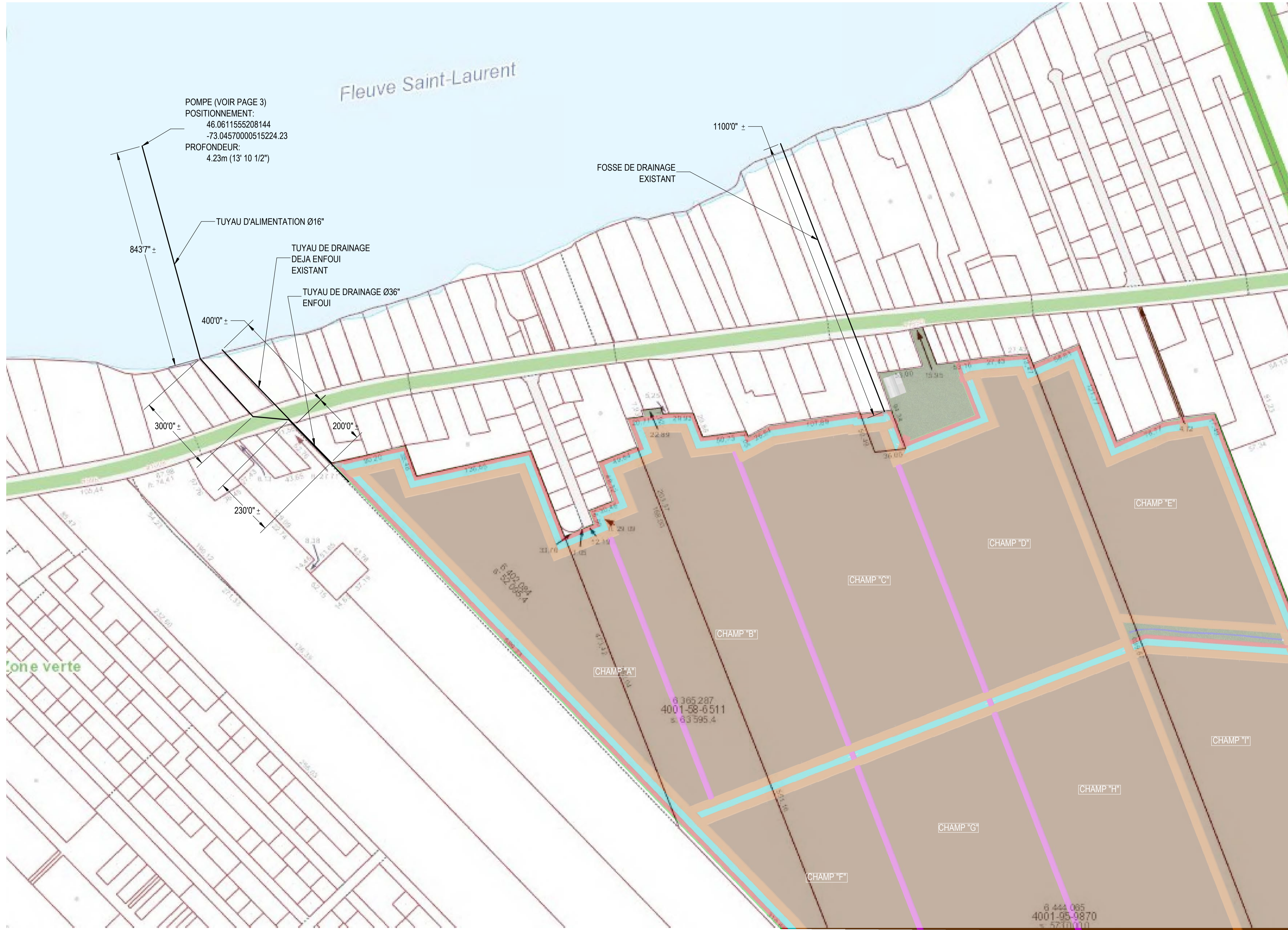
VUE EN PLAN - DETAIL DE L'ALIMENTATION ET DU DRAINAGE DES CHAMPS -
