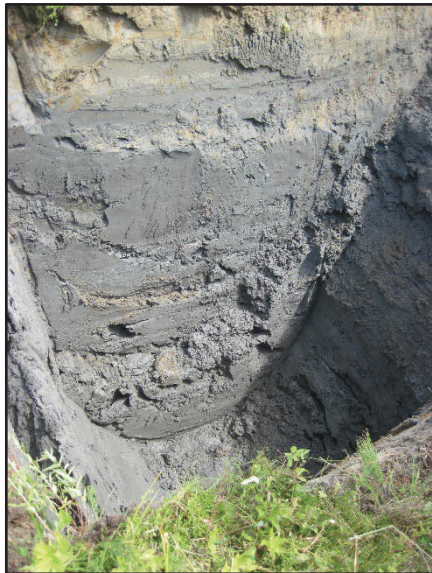
Photo 3 Vue d'une deuxième tranchée exploratoire lors de l'évaluation du matériel pour la conception d'une réserve d'eau sur le lot 6 444 065 à Sainte-Anne-de-Sorel.
