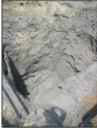
Photo 1 Vue d'une première tranchée exploratoire lors de l'évaluation du matériel pour la conception d'une réserve d'eau sur le lot 6 444 065 à Sainte-Anne-de-Sorel.
