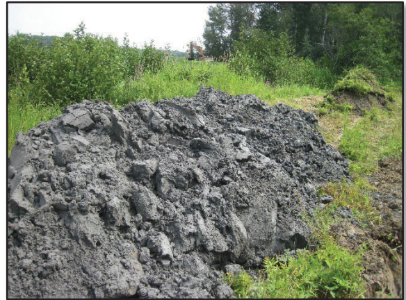
Photo 2 La cohésion du matériel indique une bonne teneur en limon et an argile
