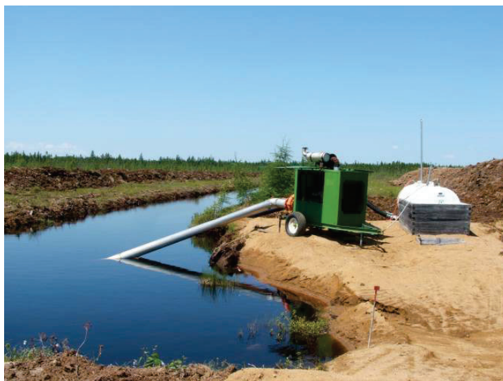
Figure 9. Pompe sur chariot mobile
